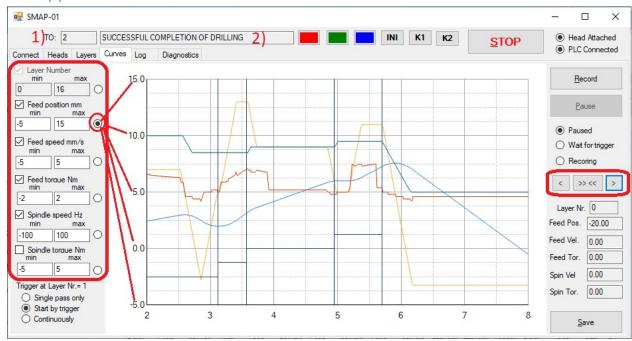
Для работы с вкладкой Curves не требуются права администратора, сверление производится в обычном режиме. Кнопки в интерфейсе вверху окна (красная, зеленая, синяя, и др.) используются лишь для отладки программного обеспечения контроллера, и в рабочей версии приложения будут скрыты. Вместо них следует использовать аппаратные электромеханические кнопки на изделии.
